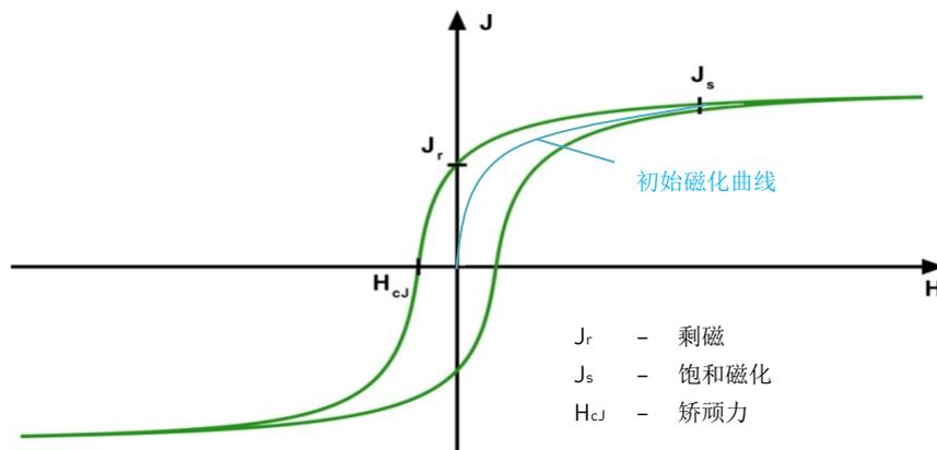
对于饱和磁极强度  $J_s$ ，磁场强度直到 200 kA/m 是完全可用的。另外，用于  $H_{cJ}$  超过 50 kA/m 的硬磁样件，高达 450 kA/m 的脉冲磁化也可做为额外的选项为客户提供。
