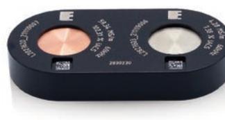
使用适当的电导率试块可用来检查和设置SIGMATEST 模块的**电导率测量**。该试块品质质量越好，最终测量结果越好。因此，即使是原材料也必须达到严格的要求。例如，材料必须具有均匀的材料结构。FOERSTER 提供的电导率试块，可溯源到NPL（英国国家物理实验室）的交流测量以及PTB（德国物理技术研究院）的直流测量。
