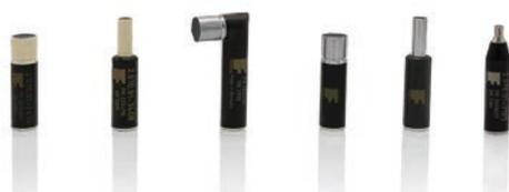
所有经过SIGMATEST 2.070系统验证过的探头都可用于电导率测量；同时我们也提供钛金属外壳的耐磨探头。以下直径都是可用的。
